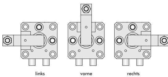
Hebel können in einer von drei Positionen im Verhältnis zu den Luftanschlüssen positioniert werden.
