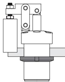
Montage mit Einführkörper in einer Bohrung ohne Gewinde und Verriegelung mit zwei Kontermuttern.
