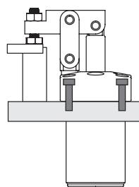
Montage mit Verschraubungskörper in einer Gewindebohrung und Verriegelung mit einer Kontermutter.
