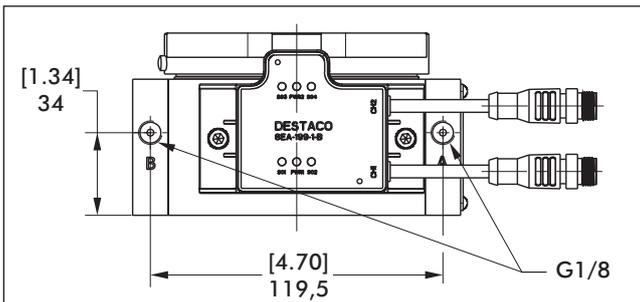
**Important !** Pour un amortissement optimal, il convient d'utiliser des régulateurs de débit unidirectionnels pneumatiques externes.
