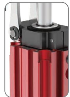
Les raynures intégrées dans le corps permettent d'accueillir des capteurs ronds de Ø4mm et des capteurs en T de 3x6mm. Des ports pneumatiques G1/8 ou 1/8 NPT sont disponibles sur toutes les tailles, à l'exception du 8822, qui n'a que des ports M5.
