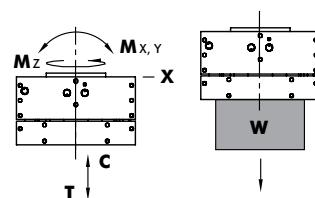
Der berechnete Wert von 1324,5 Nm muss mit den technischen Daten unserer Produkte in diesem Katalog (Abschnitt "Informationen zur Tragfähigkeit") verglichen werden. Für dieses Anwendungsbeispiel wäre das passende Produkt der Werkzeugwechsler RQC-400M, dessen Moment von 1580Nm höher ist als das für die Anwendung berechnete Moment von 1325Nm.
