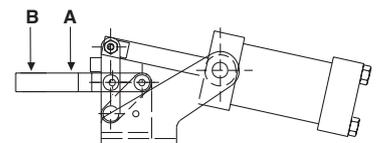
Übersetzungsverhältnis Spannkraft zu Handkraft ist abhängig von der Spindelposition
