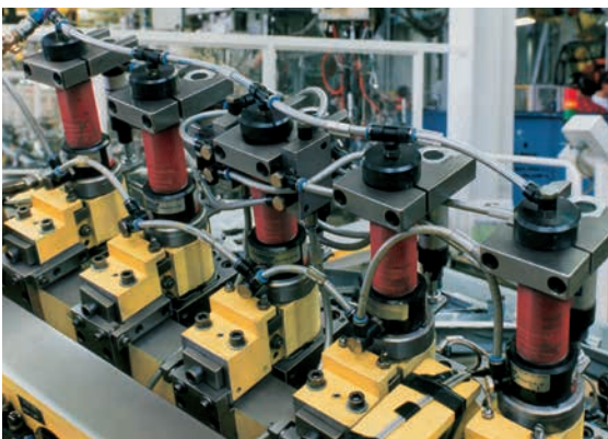
Reihenstanzanlage für Stahlblechteile
