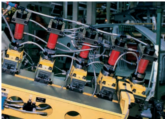
Reihenstanzanlage für Stahlblechteile
