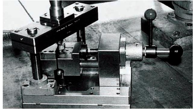
Modell FL-160 einschließlich Schubstange 16/100F an einer Stanzvorrichtung
