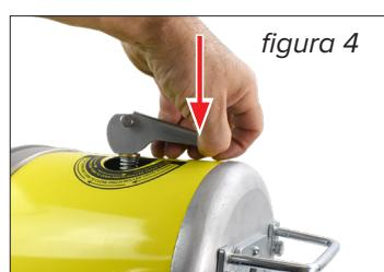
**PASO 5** Cierre el aprisionador de mensajero presionando la palanca hacia abajo y rotándola en sentido del reloj 90°. *figura 3*
