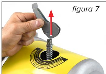
**PASO 4** Levante y retire la palanca, arandela de latón y resorte del aprisionador de mensajero. *figura 7*
