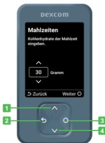
Verwenden Sie die Navigationsschaltfläche, um sich im Empfänger hin- und herzubewegen. Auf den Empfängerbildschirmen wird gezeigt, auf welche Seite der Schaltfläche gedrückt werden muss.
