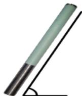
Mantenga el transmisor en la misma posición general de reloj ( $\pm 2$ ) durante todo este procedimiento. Mantenga el transmisor encendido, a nivel ( $0 \pm 10^\circ$ ), por al menos cinco segundos. Inclíne el transmisor aproximadamente  $+65^\circ$  (o casi vertical) por 10 a 18 seg., después regréselo a nivel por 10 a 18 seg. Cuando el transmisor cambia bandas, los datos desaparecen del localizador.
