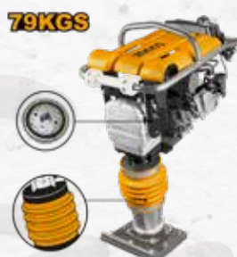
SKU: GRT75-2 BAILARINA 6.5 HP CÓDIGO - 075016 - PESO 79 KG - IMPACTO 10 KN - 450 - 660 RPM - TANQUE 2 L
