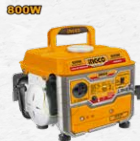
SKU: UGE8002 GENERADOR A GASOLINA CÓDIGO - 075015 - 110 - 120 V - 3600 RPM - TANQUE 4 L - 16 KG
