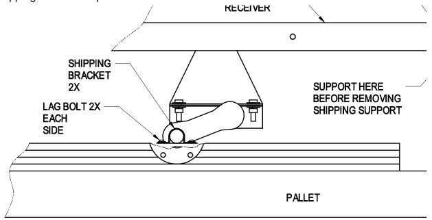
NOTE: BLOCK GRILL SECURELY BEFORE REMOVING THE SHIPPING SUPPORT AND INSTALLING THE TRAILER TONGUE.
